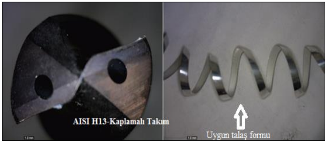
Şekil 5.3. AISI H13- Kaplamalı takım ve oluşan talaş şekli.
