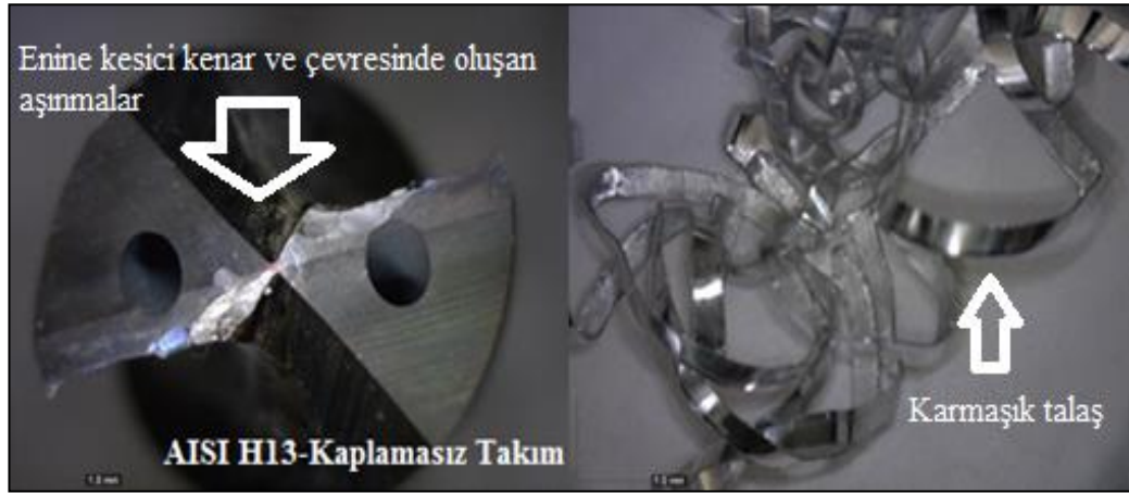
Şekil 5.2. AISI H13- Kaplamasız takım ve oluşan talaş şekli.
