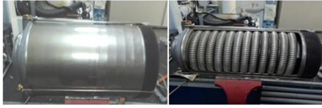
Şekil 4.7. Paslanmaz eşanjöre sahip yanma ünitesi ve sarmal eşanjör.
