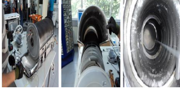
Şekil 4.27. Prop yerleştirmek için demontaj işlemi.
