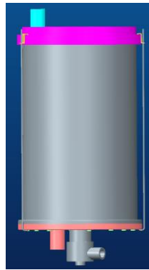
Şekil 5.1. Alüminyum eşanjör montajı.
