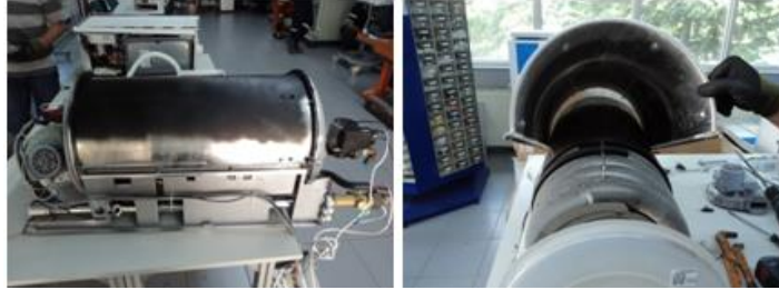
Şekil 4.9. Alüminyum eşanjöre sahip yanma ünitesi ve sarmal eşanjör.
