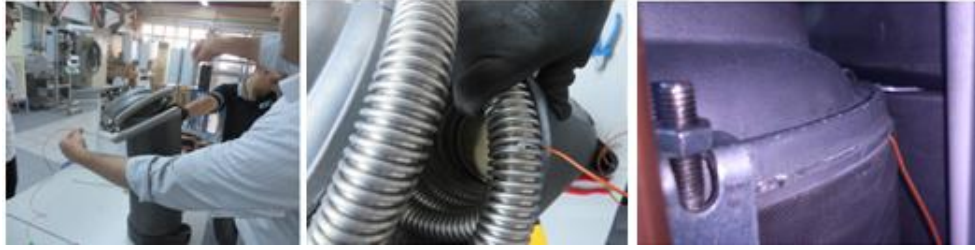
Şekil 4.22. Paslanmaz borunun yüzey sıcaklığını ölçmek için prop montajı.
