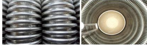
Şekil 4.8. Boğumların birbiri ile teması ve yönlendirici.
