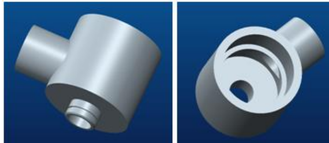
Şekil 5.16. Baca gazı ve yoğuşma suyu tahliye aparatı.
