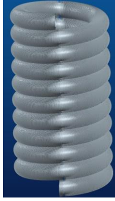
Şekil 4.14. Mevcut alüminyum malzemedan yapılan eşanjörün tasarımı.
