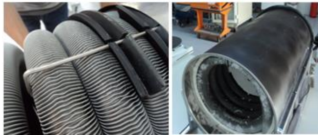
Şekil 4.10. Finlerin ve yönlendiricinin montajı.
