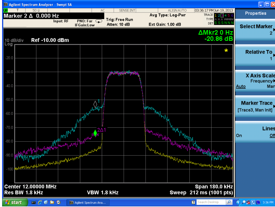
Şekil 5.24. 4.8 MHz merkez frekansında gerçekleştirilen geri yönlü modellemenin 12 MHz merkez frekansındaki DPD uygulaması, giriş işareti (sarı), DPD çıkışı (magenta), GY çıkışı (mavi).
