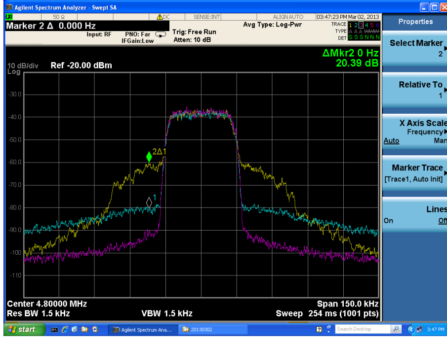
Şekil 5.15. -5 dBm RF güç seviyesinde yapılan ölçüme ait DPD modellemesi sonucu VSA ekran görüntüsü, giriş işareti (magenta), DPD çıkışı (mavi), GY çıkışı (sarı).
