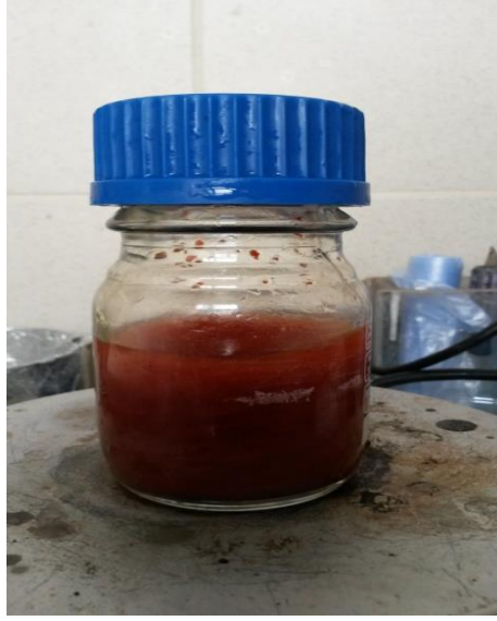
Şekil 4.1. Manyetik karıştırıcı ile etanol içinde kırmızı biberin ekstraksiyon işlemi.
