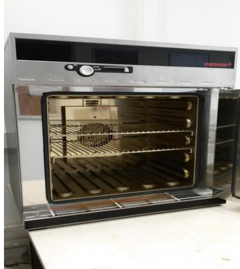
Şekil 4.2. Vakum altında ekstraksiyonun kurutulduğu fırın.
