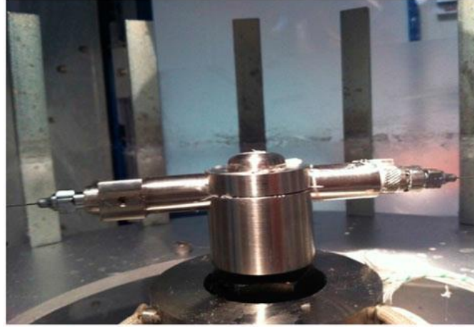
Şekil 2.9. M. A. Hammami ve ekibinin üretim yaptığı santrifüj eğirme cihazı [35].
