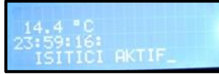
Şekil 7.2. Isıtıcı peltierin aktif olduğu zaman.
