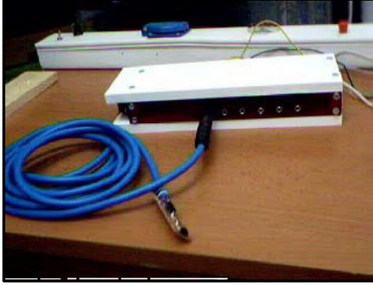
Şekil 4.5. Kanal pic datalogger.
