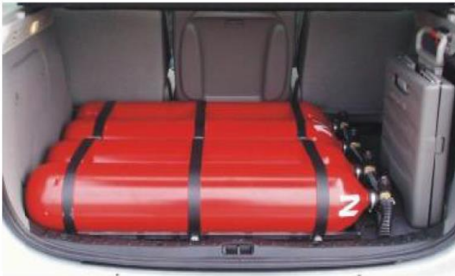
Şekil 1.8. Taşıt bagajına yerleştirilmiş doğalgaz tankları.
