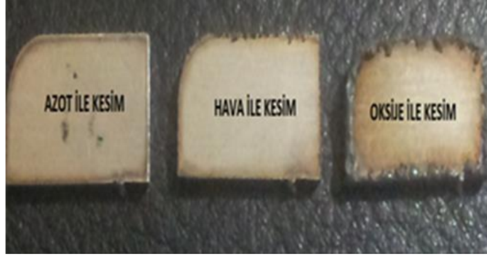
Şekil 3.7. Lazerde kullanılan soğutucu gaz uygulamaları: a) Azot ile kesim, b) Hava ile kesim, c) Oksijen ile kesim
