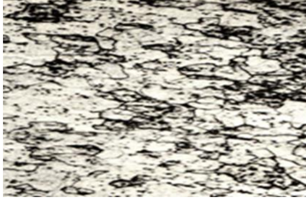
Şekil 6.4. % 18 krom ve % 0,03 karbon içeren bir ferritik paslanmaz çeliğin mikro yapısı görülmektedir. 1150 °C ‘den hızlı soğutulmuştur. (x500).
