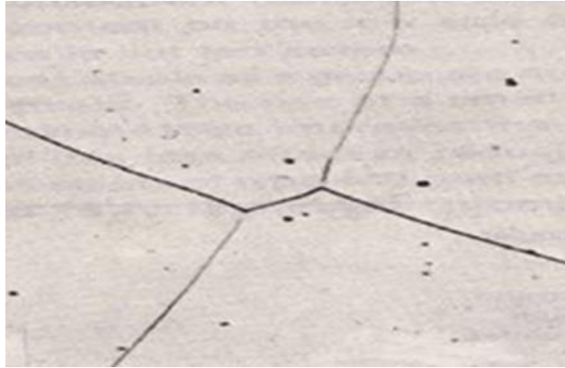
Şekil 6.3. % 12 Krom içeren ferritik bir mikro yapı görülmektedir. Küçük karbür parçacıkları da mevcuttur. Malzeme tavllanmış bir malzemedir (x500).
