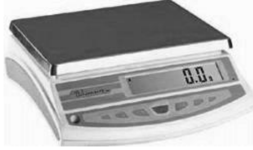
Şekil 6.6. Testlerde kullanılan hassas terazi.
