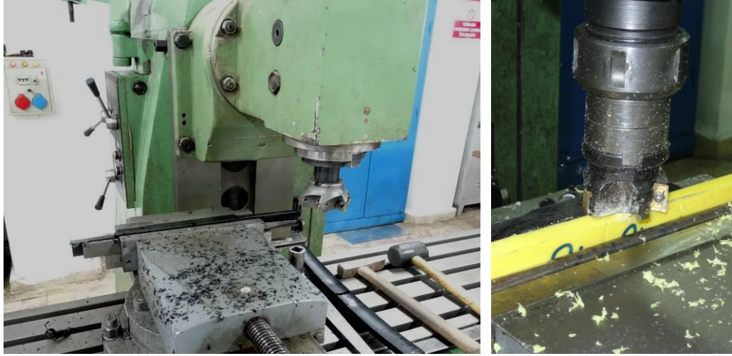
Şekil 3.14. Frezede işlenen çekme soyma-ayrılma numunesi.
