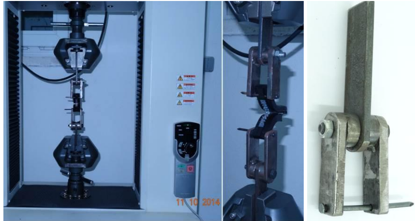
Şekil 3.20. Çiftli çekme soyma-ayrılma testi için numune tutucusu.
