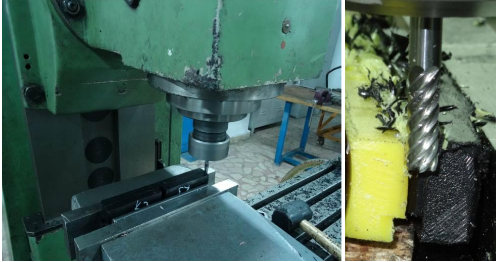
Şekil 3.18. Frezede işlenerek hazırlanan çiftli çekme soyma-ayrılma numunesi.
