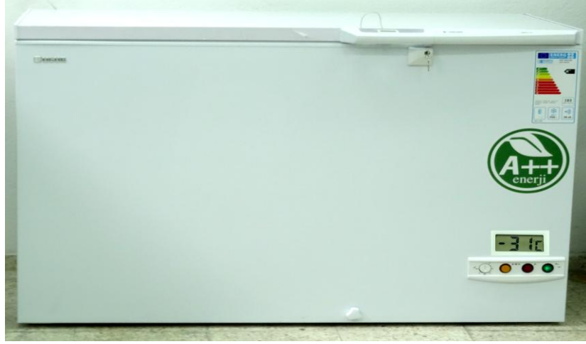
Şekil 3.6. Düşük çevre sıcaklıklarında kaynağın gerçekleştirildiği derin dondurucu.
