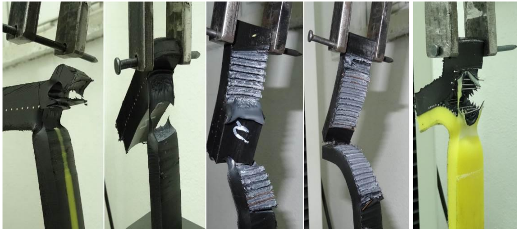
Şekil. 3.17. Tekli çekme soyma-ayrılma numuneleri ayrılma biçimleri.
