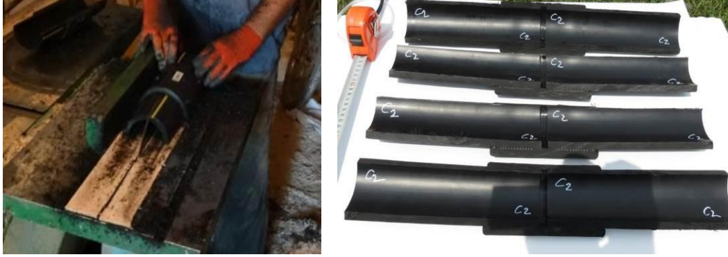
Şekil 3.11. Kaynaklı doğalgaz borularının kesilerek dört eşit parçaya bölünmesi.
