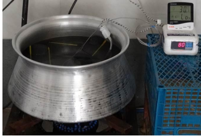
Şekil 3.7. Deney numunelerine uygulanan ön tav ısıtma işlemi.
