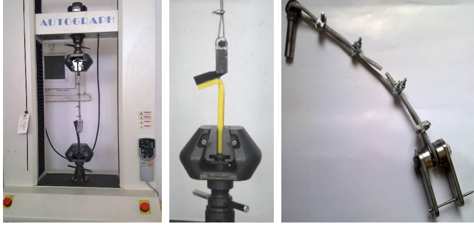
Şekil 3.16. Çekme test cihazı ve tekli çekme soyma-ayrılma test numunesi tutucusu.
