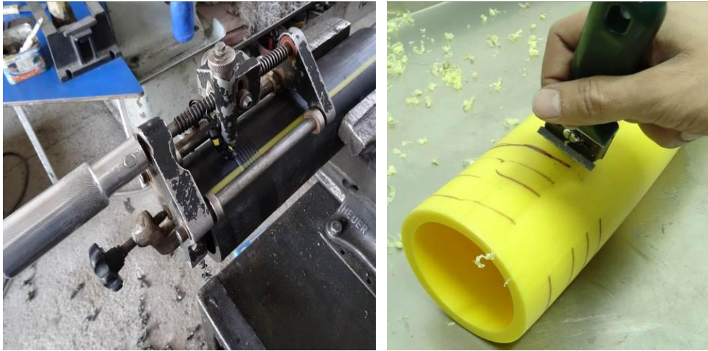
Şekil 3.5. Borularının kazıma işlemi.
