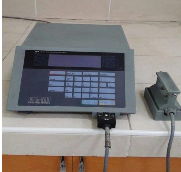
řekil 2. 2. QTM-500 cihazı ile ısı iletkenlik katsayısı deneyi.
