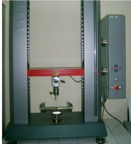
Şekil 4.8. Eğilme direnci testi [81].
