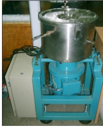
Şekil 4.3. Polimer kompozit üretiminde kullanılan karıştırıcı [81].
