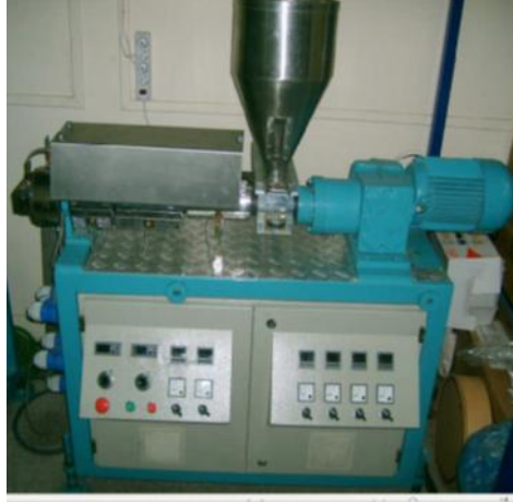
Şekil 4.4. Polimer kompozit üretiminde kullanılan tek vidalı ekstruder [81].
