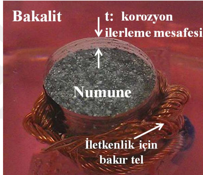
Şekil 7.33. Potansiyodinamik polarizasyon deneyi sonrası hasara uğramış numunede korozyon ilerleme görüntüsü.
