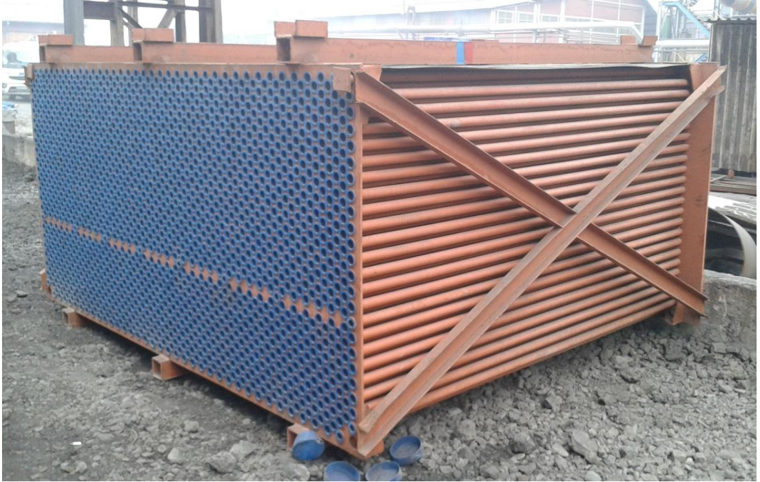
Şekil 3.11. Hava ekonomizerlerinin genel görünüşü.
