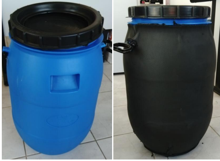
Şekil 5.9. Isı yalıtımı yapılmış varil.
