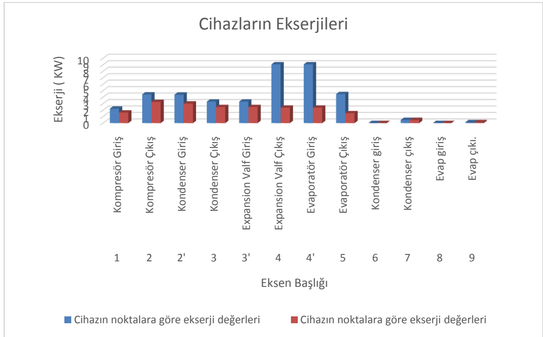
Şekil 8.3. Cihazların aynı bölgedeki ekserjilerinin karşılaştırılması.
