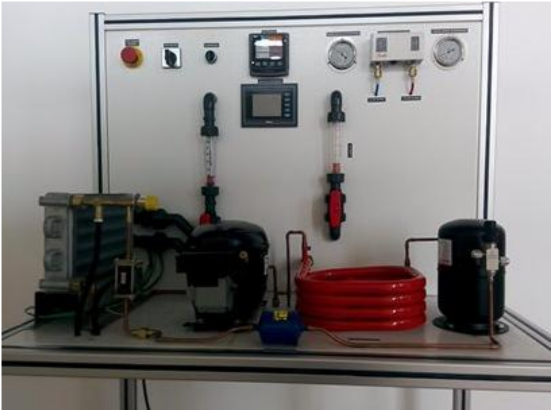
Şekil 7.1. Su kaynaklı ısı pompası deney düzeneği.
