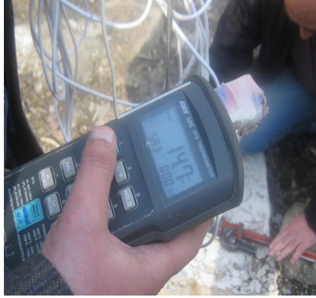
Şekil 5.2. Termometrenin ölçü almak üzere kuyuya bağlanması.
