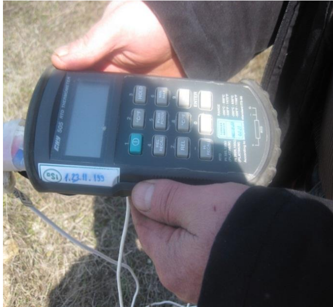
Şekil 5.11. Termometrenin ölçü almak podaya bağlanması.
