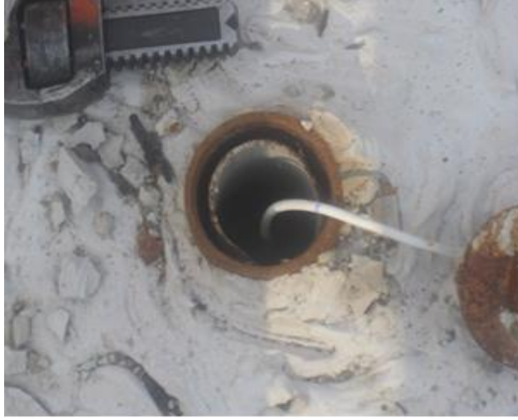
Şekil 5.4. Termometre podunun kuyuya yerleştirilmesi.
