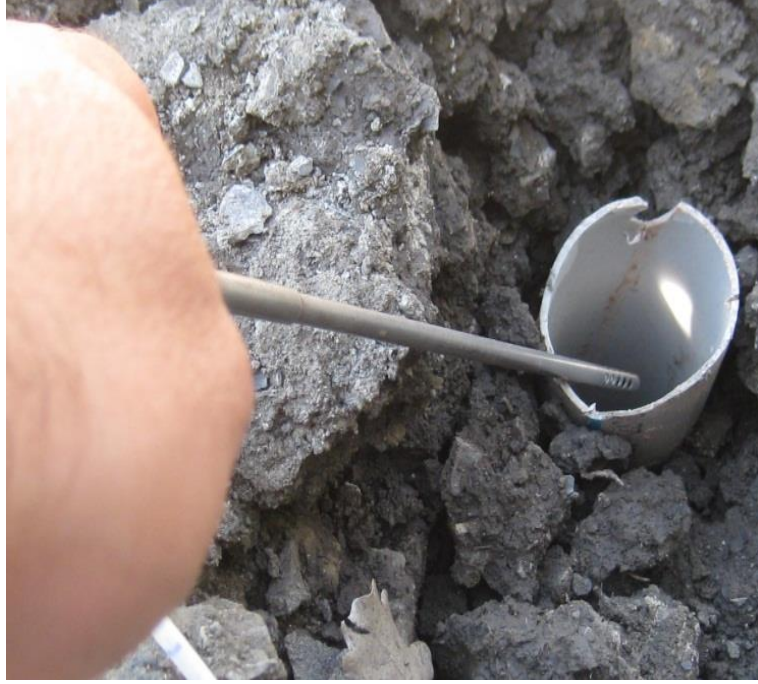
Şekil 5.10. Termometrenin kuyu ağzından ölçü alma işlemi.
