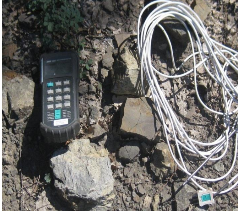
Şekil 5.7. Ölçme işlemi öncesi termometre ve podun hazırlanması.
