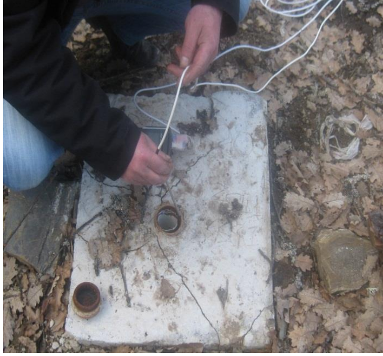
Şekil 5.6. Termometrenin ölçü almak üzere kuyuya bağlanması.
