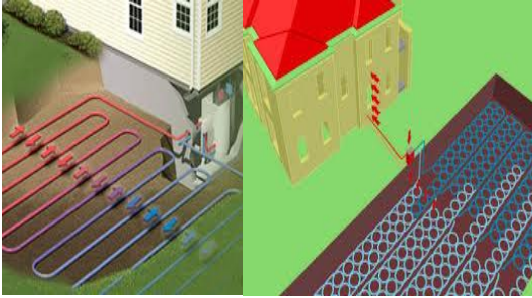
Şekil 3.6. Klasik ve Slinky tipli borulama tekniği.
