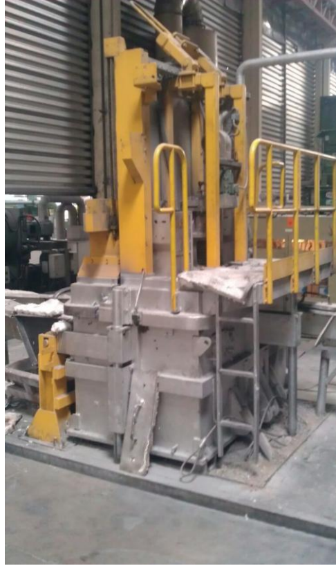
Şekil 7.2. Alpur marka gaz giderme makinası.
