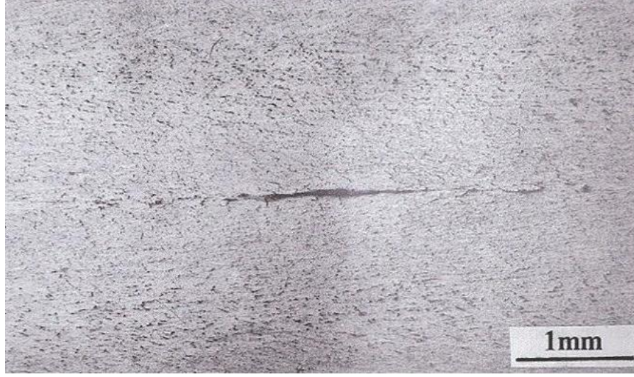
Şekil 4.6. AA8011 alaşımında merkez hattı ve bandsı segregasyon (Ertan, 2000)
