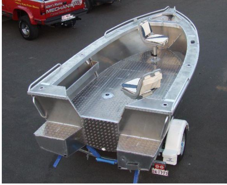
Şekil 2.7. Alüminyum levha malzeme kullanılan bir tekne imalatı.
