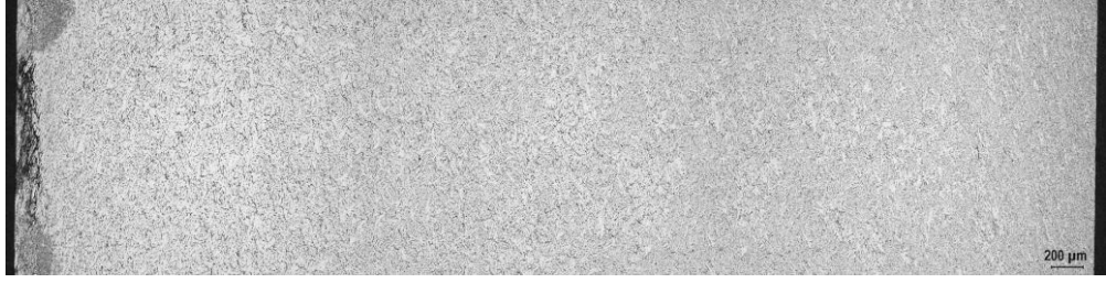
Şekil 8.27. % 3,2 Mg içeren malzemenin kenar ve merkez bölgesindeki mikroyapı görüntüsü, a) kenar, b) merkez.
