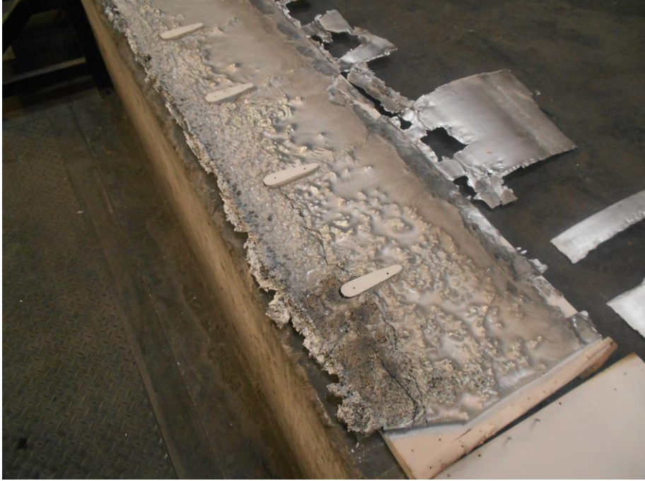
Şekil 8.2. Tip malzeme içindeki oksit tabakası.
