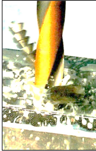
Şekil 3.2. Delik delme işlemi [36].
