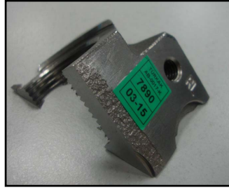
Şekil 6.6. Kapak plakasından analiz için kesilmiş numune.
