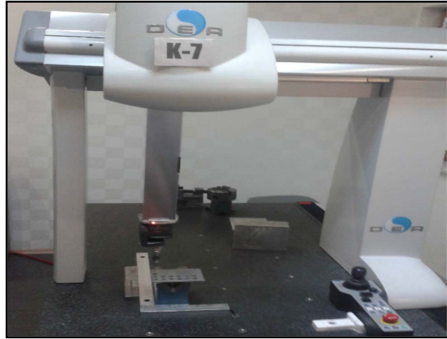
Şekil 5.7. Delik çapı ve daireselliklerinin ölçüldüğü CMM tezgahı.
