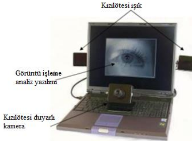
Şekil 2.17. Göz bebeği ve kornea yansıması sistemi [18].
