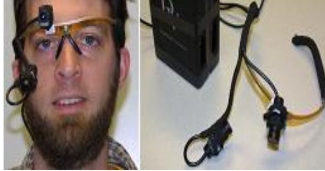
Şekil 2.13. Göz bebeği ve limbus izlemek için geliştirilen kafaya monte gözlük tasarımı [34].
