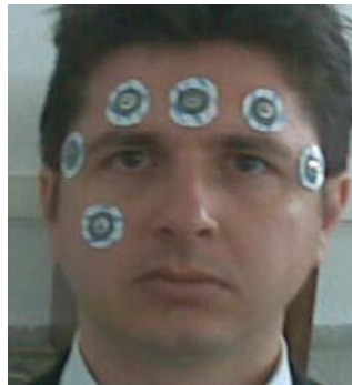
Şekil 2.6. Elektrotların kullanıcının göz çevresine yerleştirilmesi [24].
