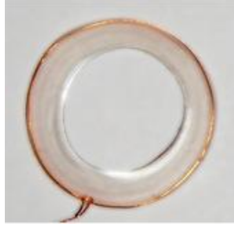
Şekil 2.7. Manyetik arama bobin kontak lens [8].
