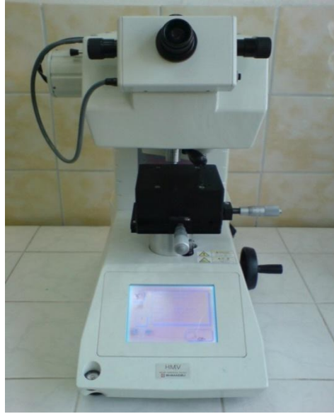
Şekil 4.4. Schimadzu marka HMV model mikro sertlik cihazı.
