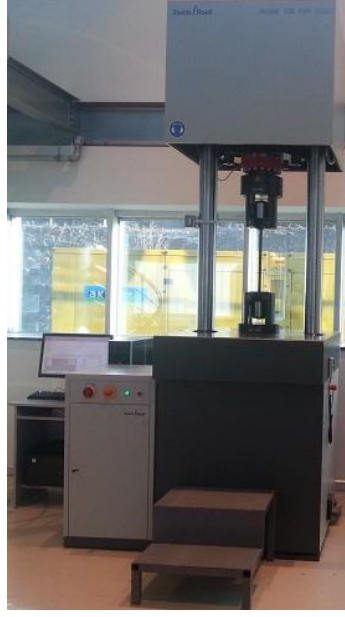
Şekil 4.6. ZWICK/ROELL Amsler 500 HFP 5100 manyetik rezonans yorulma cihazı.
