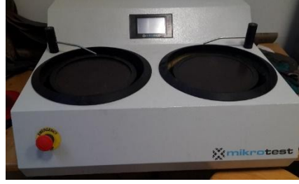
Şekil 4.1. Mikro test otomatik parlatma ve zımparalama cihazı.
