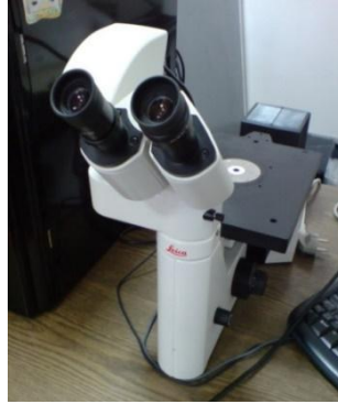
Şekil 4.2. Lecia marka DMILM model optik ışık mikroskobu.
