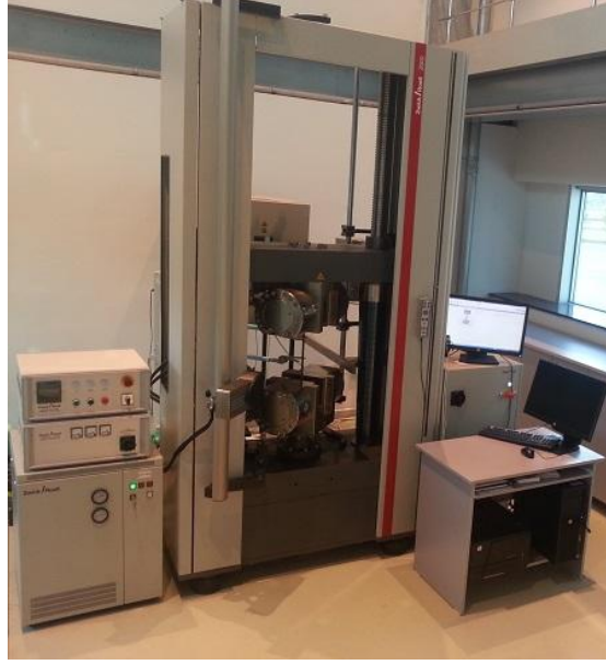
Şekil 4.5. Zwick/Roell SP 1200 çekme cihazı.
