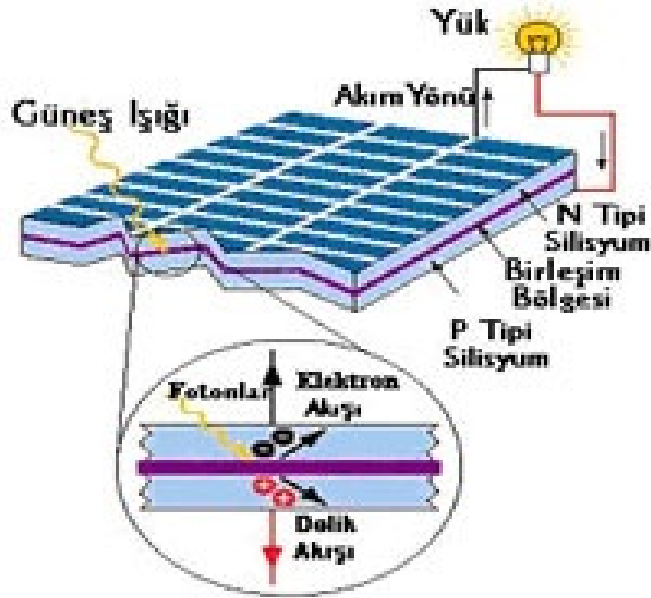
Şekil 3.4. PV hücrenin yapısı ve fotovoltaik etki [20].
