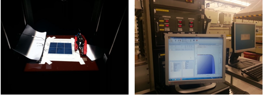
Şekil 3.14. Hücre V-I karakteristiği için deney kurulumu.
