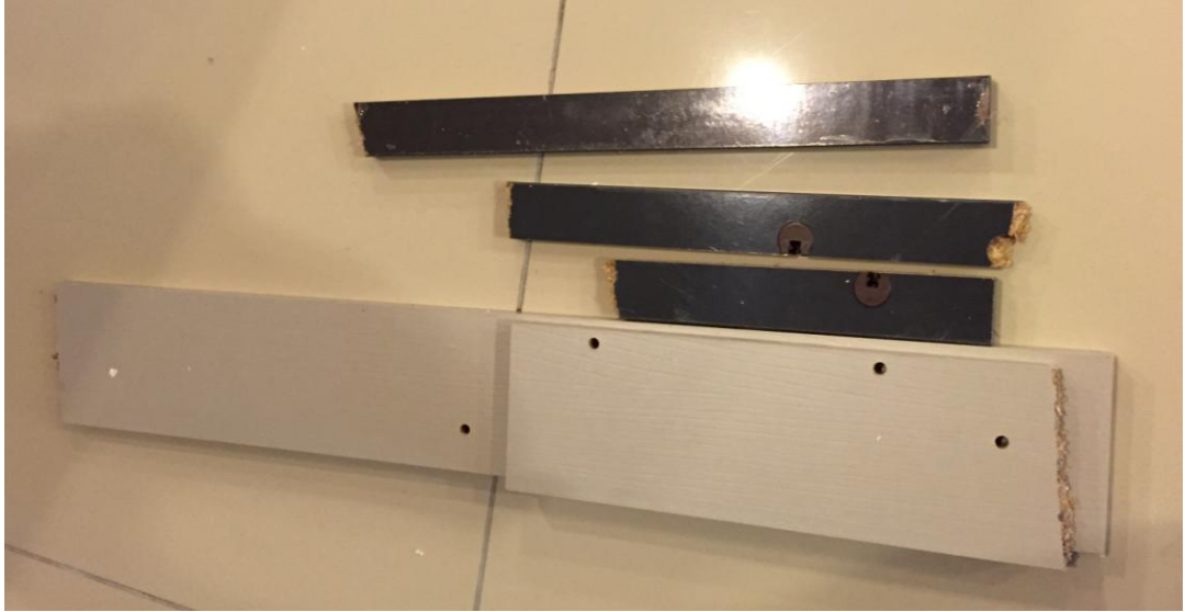
b) Paketlemeden kaynaklanan parça hasarları.
