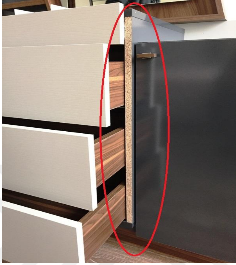
a) Bantlamadan kaynaklanan parça hasarları.
