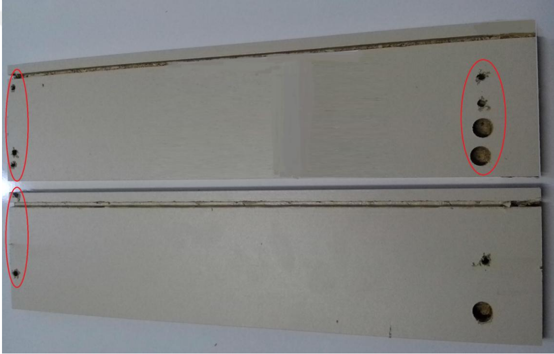
Şekil 5.8. Delik delerken, parçanın kayması sonucunda oluşan hata.
