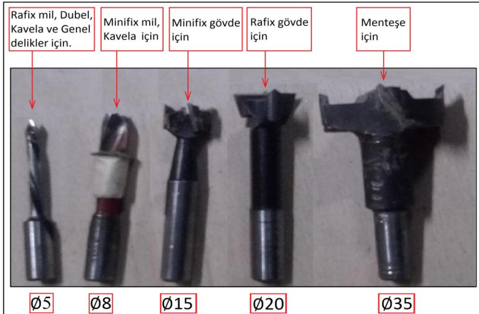
Şekil 5.15. Delik derinlik ve eksikliklerine karşı alınan tedbir.
