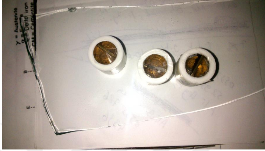
Şekil 6.5. Soğuk bakalite alınmış numuneler.
