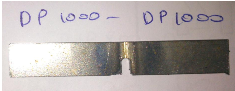
Şekil 6.14. DP 1000/DP 1000 darbe testi numunesi.
