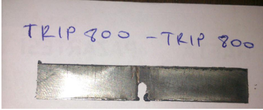
Şekil 6.15. TRIP 800/TRIP 800 darbe testi numunesi.
