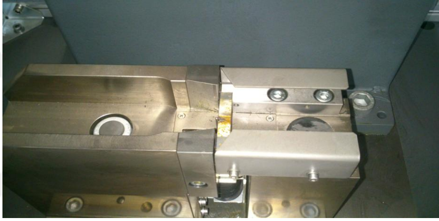
Şekil 6.16. Test numunesinin cihaza yerleştirilmesi.
