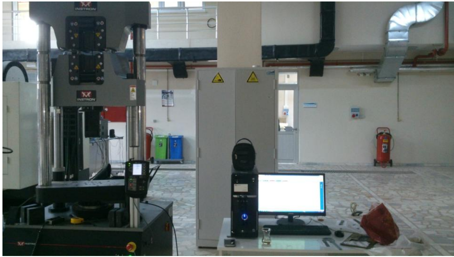
Şekil 6.10. Çekme testlerinde kullanılan çekme testi cihazı.
