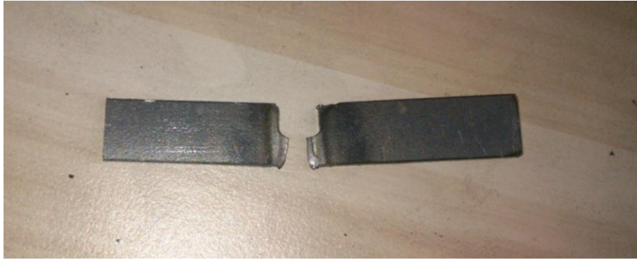
Şekil 7.52. Çentik darbe deneyi sonucu kırılan bir numune.
