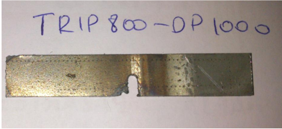
Şekil 6.12. TRIP 800/DP 1000 darbe testi numunesi.
