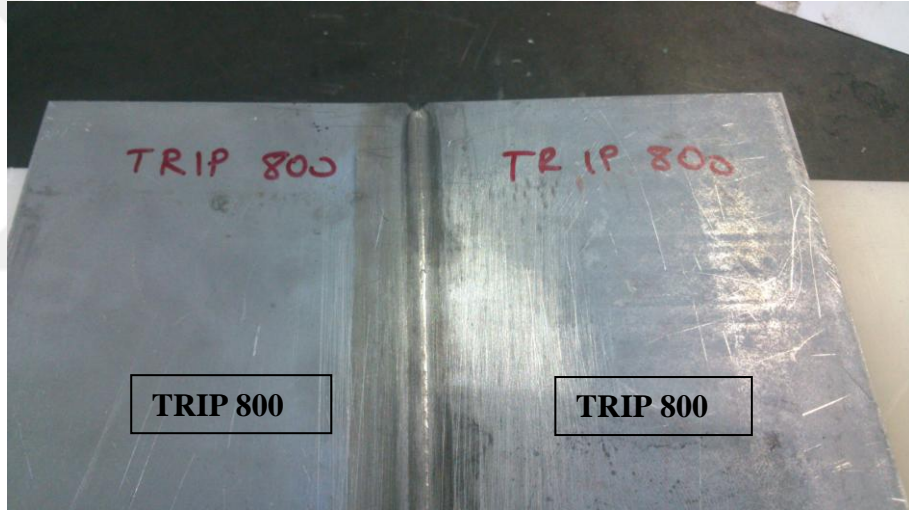
Şekil 6.4. TRIP 800/ TRIP800 numunesinin EİK ile birleştirilmesi.
