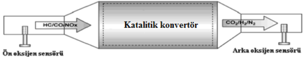
Şekil 3.15. Kapalı devre lamda kontrol sisteminin şematik resmi [65].
