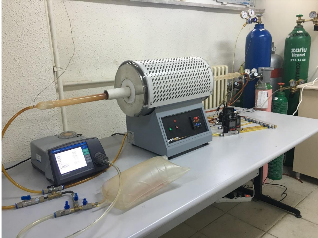
Şekil 5.10. Katalizör aktivite test düzeneğinin fotoğrafı.
