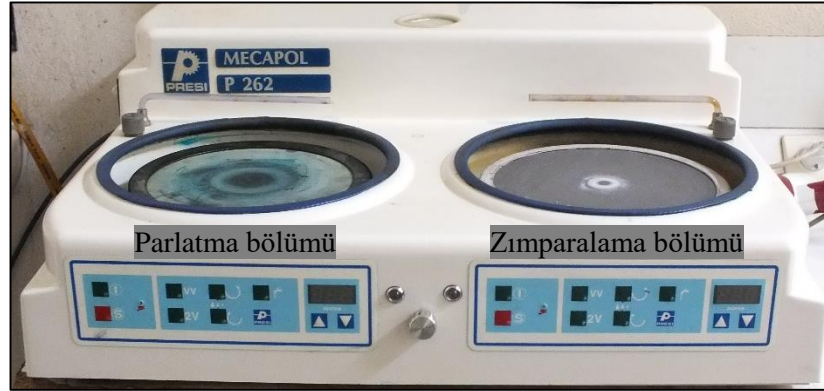
Şekil 4.16. Presi Mecapol P262 zımparalama ve parlatma cihazı.
