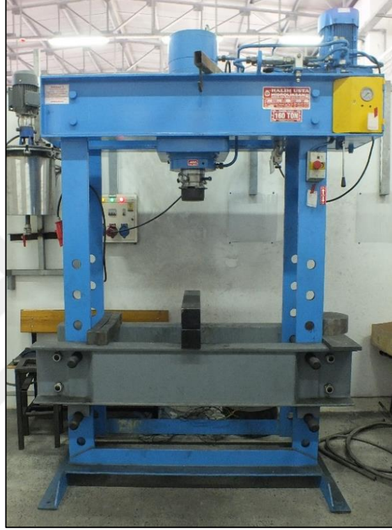
Şekil 4.10. Çalışmada kullanılan 160 ton kapasiteli hidrolik pres.
