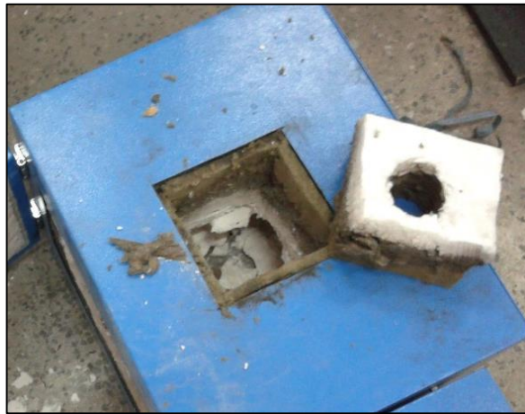
Şekil 4.5. Fırın tavanına açılan kapak.
