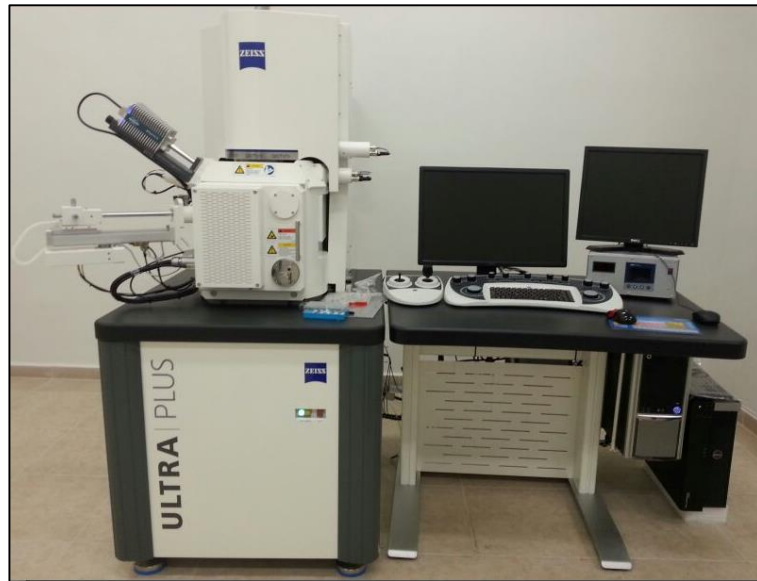
Şekil 4.20. Carl Zeiss Ultra Plus Gemini FESEM cihazı.
