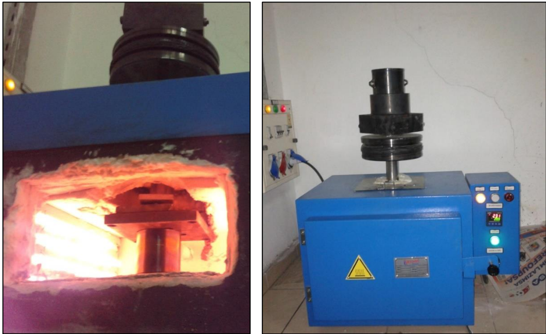
Şekil 4.12. İşlevsel fırın içerisindeki kalıbın ve kalıp üzerindeki ağırlıkların yerleşimi.
