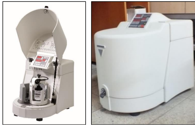
Şekil 4.7. Fritsch Pulverisette 6, tek hücreli bilyeli öğütme cihazı [55].
