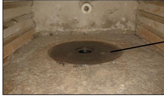
Şekil 4.3. Kalıbın oturacağı parça yüzeyinin fırın içerisindeki görünümü.
