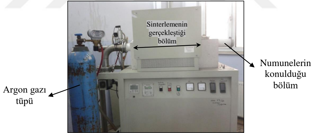
Şekil 4.14. Çalışmada kullanılan sinterleme fırını.
