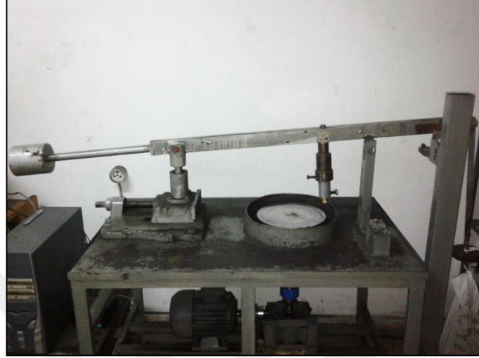
Şekil 4.19. Çalışmada kullanılan pin-on-disk tipi aşınma cihazı.
