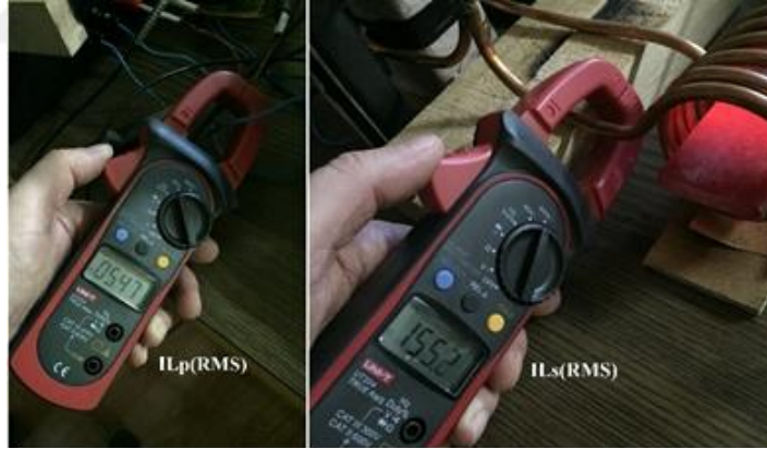
Şekil 5.24. YFT primer ve sekonder akımları.
