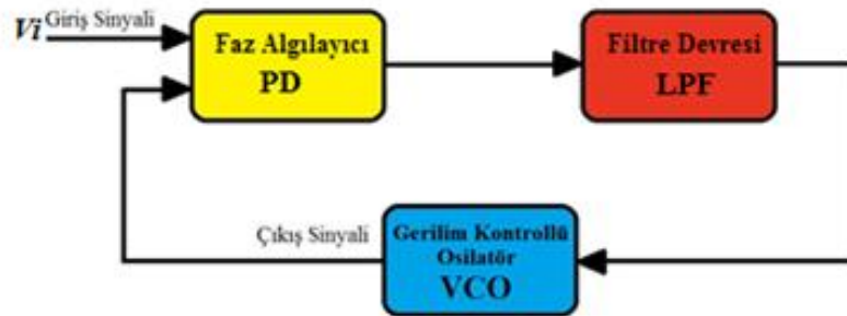
Şekil 4.1. PLL blok diyagramı.
