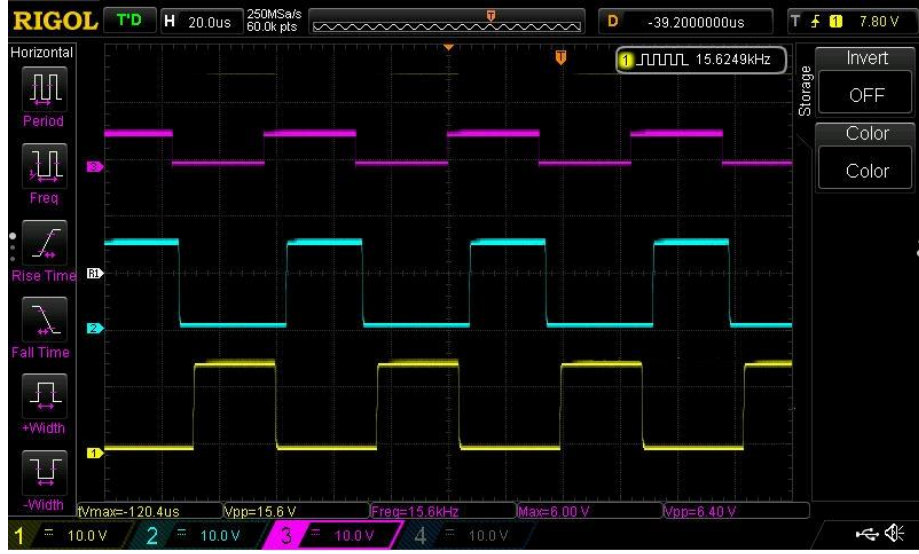
Şekil 5.10. PWM giriş sinyali ve sürücü çıkış sinyalleri (-- PLC çıkışındaki PWM, -- Sürücü çıkışı HO -- Sürücü çıkışı LO).
