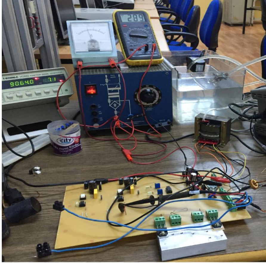
Şekil 5.5. İzoleli MOSFET sürücü devre.
