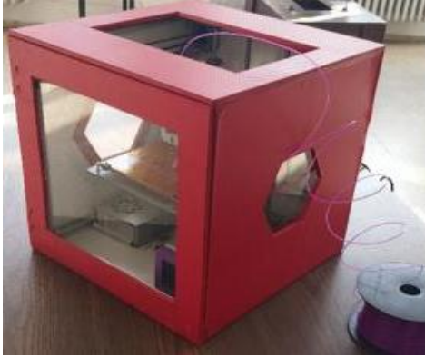
Şekil 2.2. Kapalı kabin coreXY tipi yazıcı ve teknik özellikleri [32].
