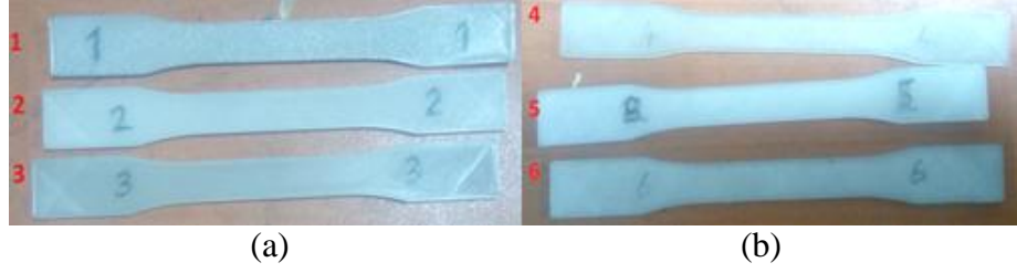
Şekil 7.12. 3B Yazıcıda yazdırılan PLA çekme numuneleri. a) üretilmiş. b) ticari.
