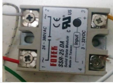
Şekil 4.14. Sıcaklık kontrol rölesi.
