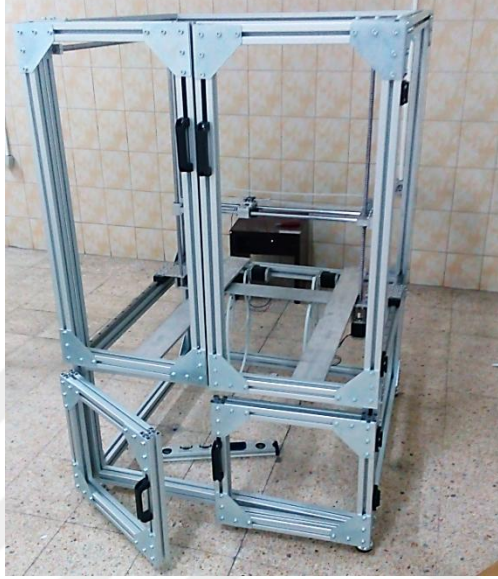
Şekil 3.8. Ön kapakların gövdeye montaj edilmiş durumu.
