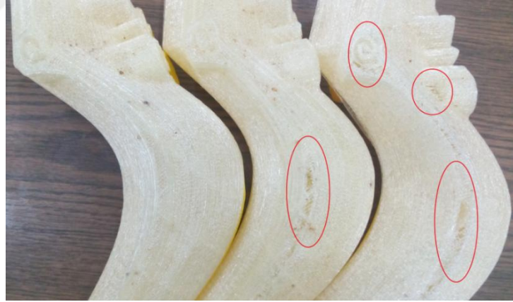
Şekil 7.25. Sehpa ayağı baskı numuneleri hataları. a) 40 mm/s yazdırma hızında numune. b) 50 mm/s yazdırma hızında numune. c) 60 mm/s yazdırma hızında numune.
