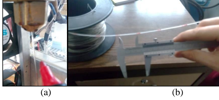
Şekil 7.9. Filament üretim hızı ölçümü. a) İşaretleme. b) Ölçüm.
