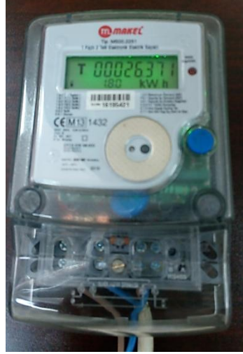
Şekil 7.7. Elektrik ölçümleri için kullanılan elektronik elektrik sayacı.
