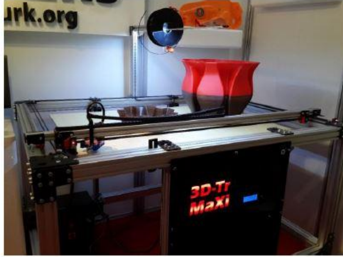
Şekil 2.6. 3D TR Maxi 2 isimli endüstriyel boyutlu üç boyutlu yazıcı [34].
