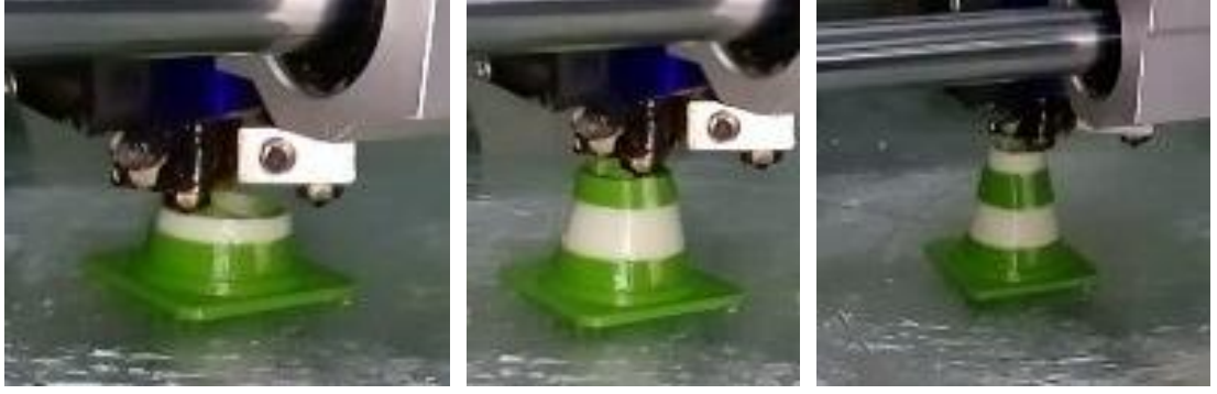
Şekil 7.31. Çift kafa çift renk baskı numunesi baskı görüntüleri.
