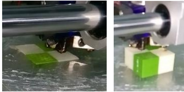
Şekil 7.30. Çift kafa çift renk baskı numunesi baskı görünümleri.
