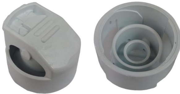
Şekil 4.3. Yuva kapak tasarımının revize edilmiş ve basılmış ürün resmi.
