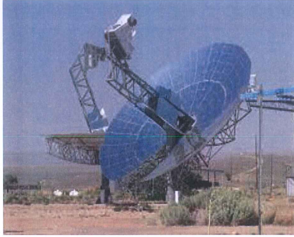
Şekil 2.3. Paraboloidal çanak tipi yoğunlaştırıcılar (Bilgiustam, 2009).
