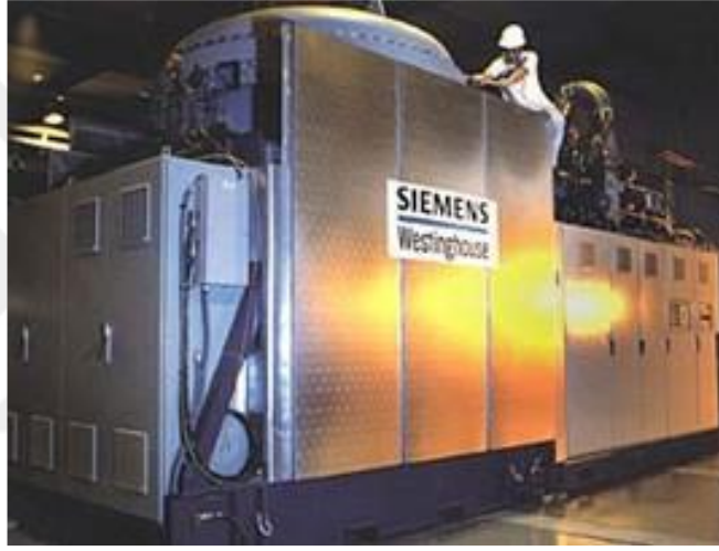
Şekil 3.5. Gaz türbinli, yakıt hücresel kojenerasyon sistemi.
