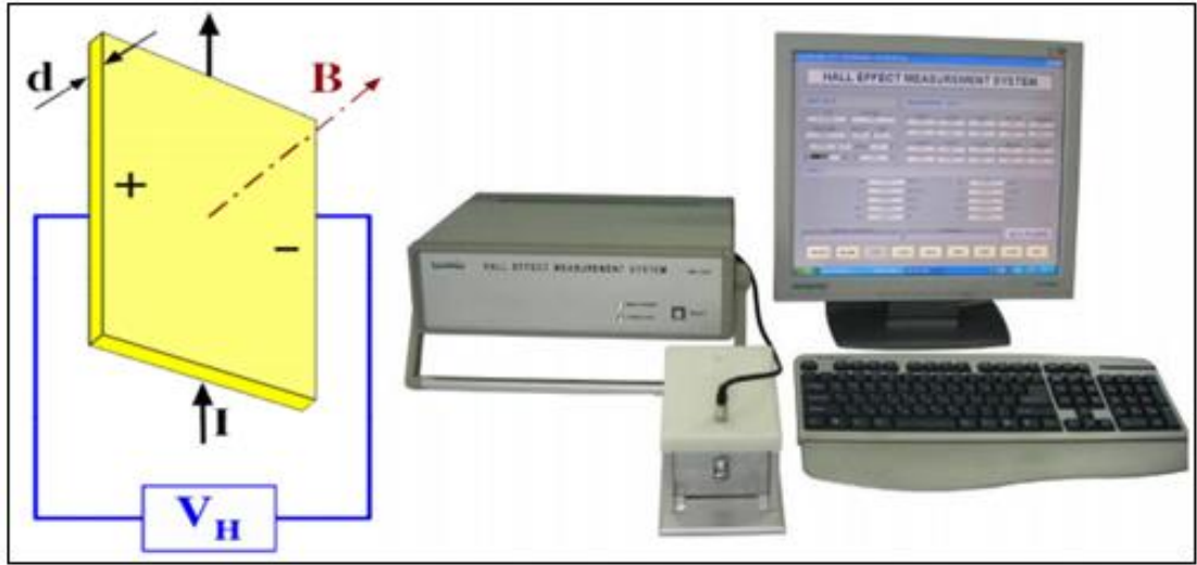
Şekil 5.5. Hall sistemi çalışma prensibi ve hall sistemi.
