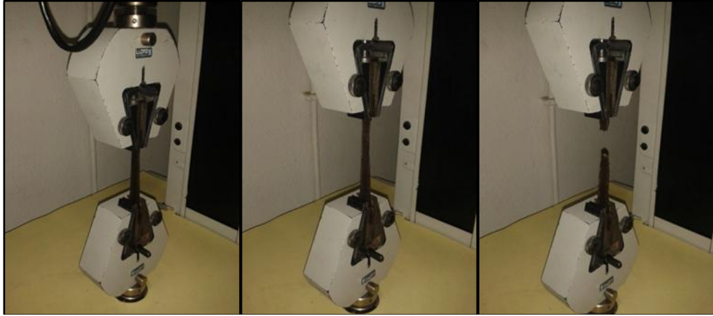
Şekil 3.9. Çekme testinde plakanın kopma anı.
