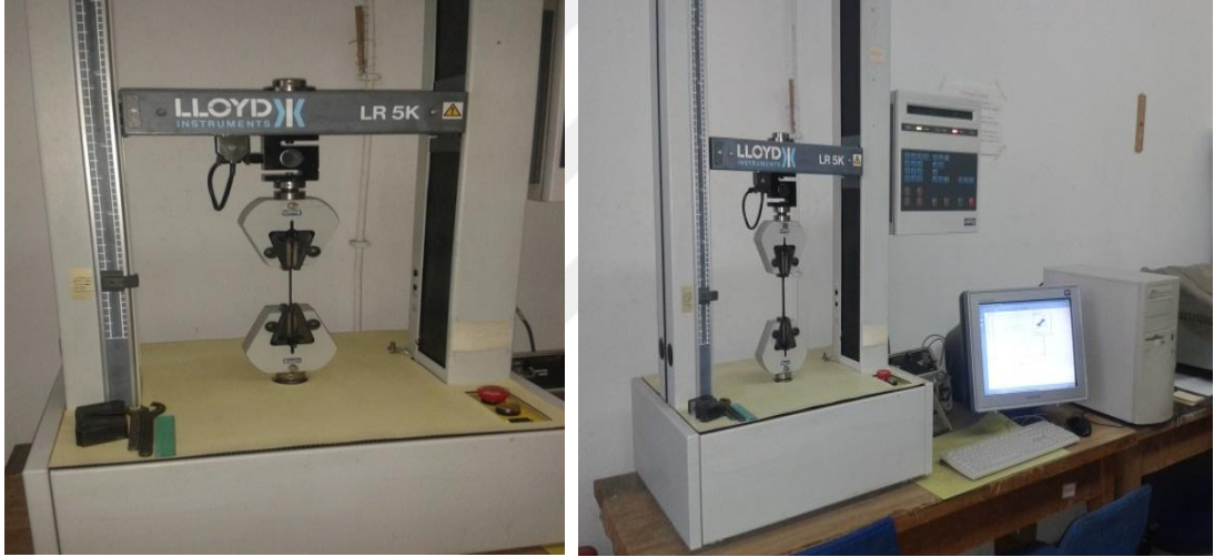
Şekil 3.3. Deneylerde kullanılan çekme test cihazı. Lloyd LR 5K üniversal gerilme test makinesi.
