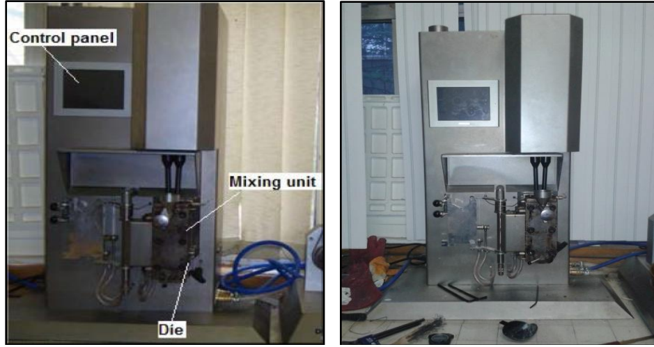
Şekil 3.1. DSM Xplore çift vidalı mikro karıştırıcı.
