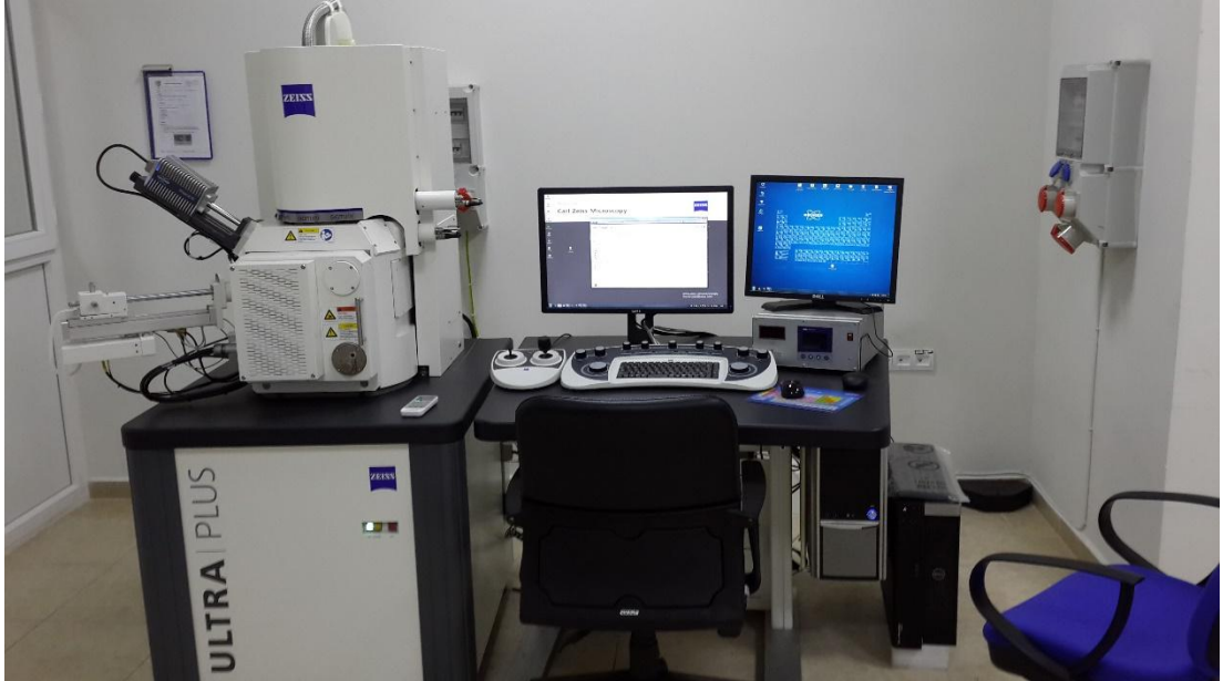
Şekil 3.8. SEM cihazı (Carl Zeiss Ultra Plus Gemini FESEM).
