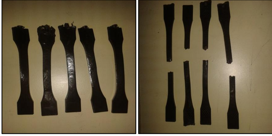
Şekil 3.10. Çekme testi öncesi a) ve sonrası b) test numuneleri.
