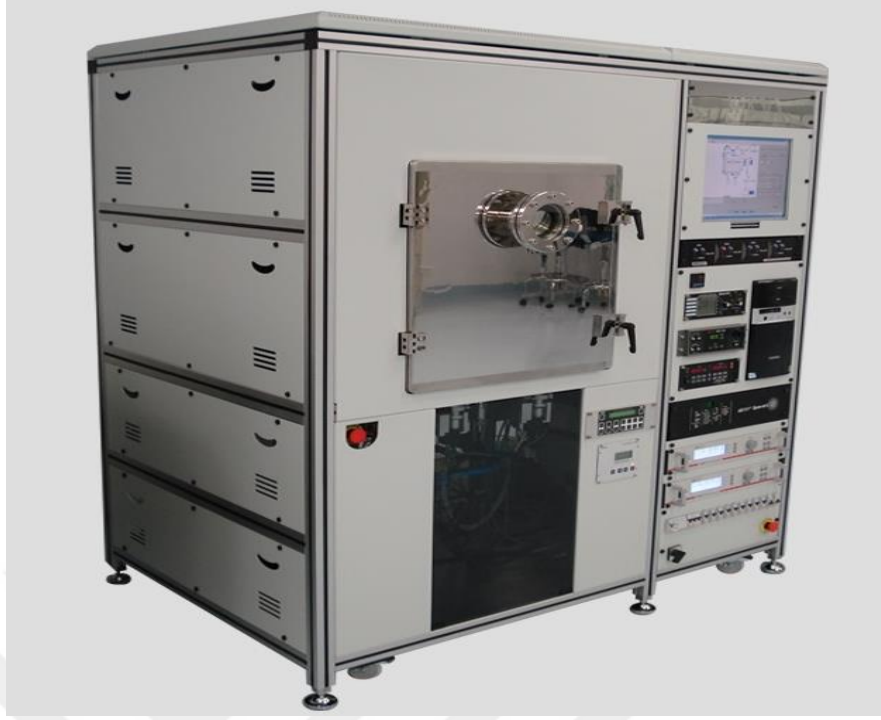
Şekil 3.12. Vaksis MIDAS termal buharlaştırma PVD/3T cihazının fotoğrafı.
