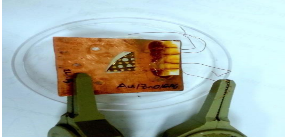
Şekil 3.16. Hazırlanan Au/ZnO/n-GaAs Schottky engel diyot.
