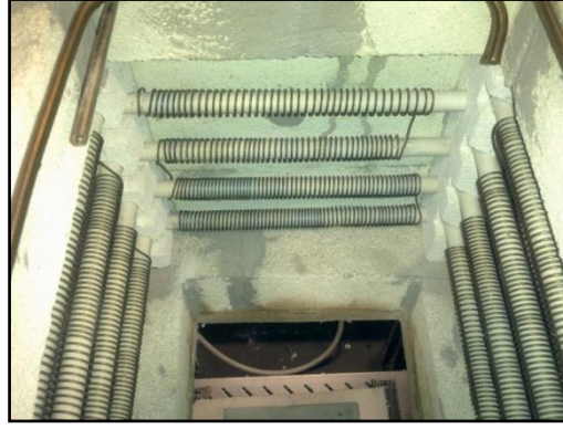
Şekil 3.2. Fırın duvarına yerleştirilen rezistanslar.
