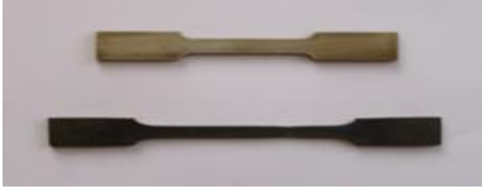
Şekil 5.11. Çekme deneyi sonrası maksimum uzama gösteren parça ile orijinal parçanın görünümü.
