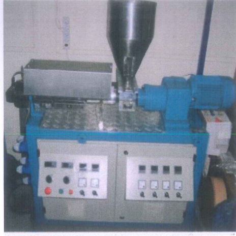
Şekil 4.2. Odun plastik kompozit üretiminde kullanılan tek vidalı ekstruder [60].
