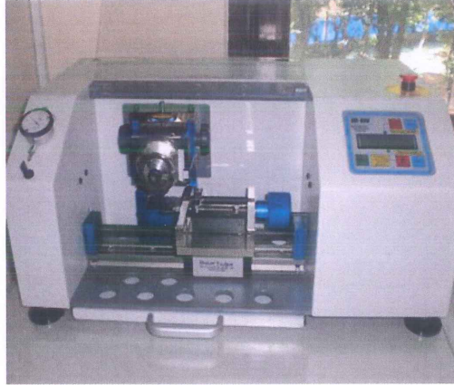
Şekil 4.8. Polytest rayran çentik açma cihazı [60].
