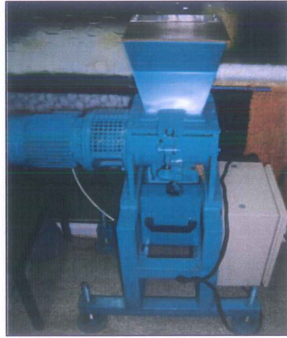
Şekil 4.3. Laboratuvar tipi kırıcı [60].
