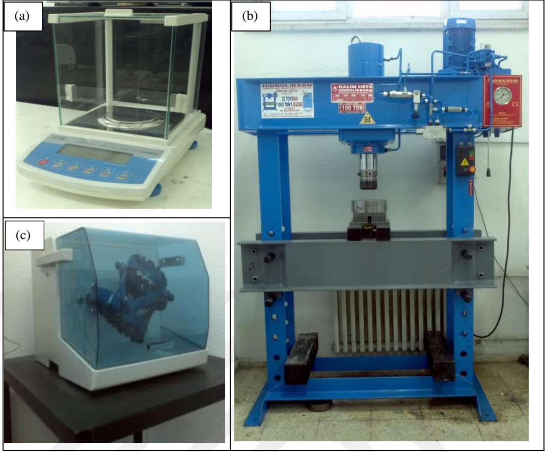
Şekil 5.2. Deneysel çalışmalarda kullanılan a) hassas terazi, b) hidrolik pres ve c) turbula cihazı görüntüleri.
