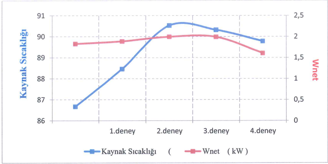
Şekil 7.5. R22 akışkanının kaynak sıcaklığına bağlı ürettiği enerji değerleri.
