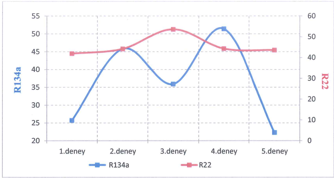
Şekil 7.9. R134a – R22 akışkanının termal verimlerinin karşılaştırılması.
