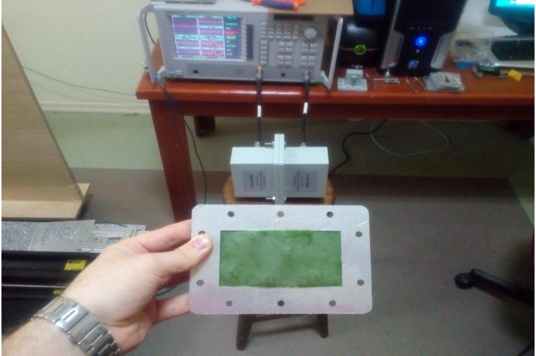
Şekil 4.14. Örneğin boşluk kalmadan yerleştirilmiş hali.
