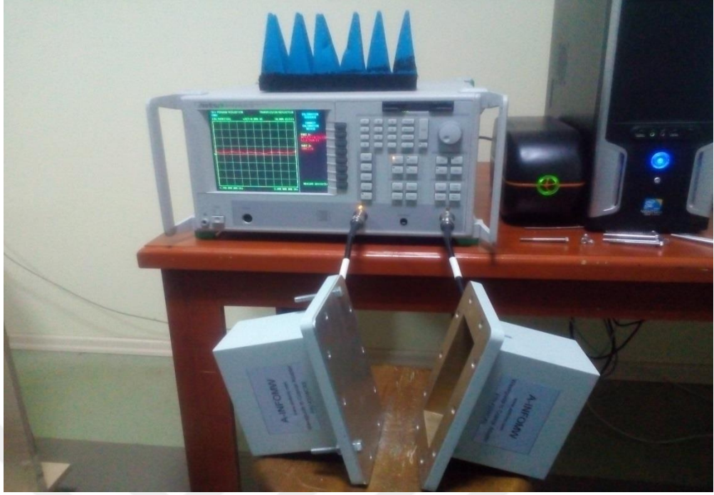
Şekil 4.3. 1. Portun yansımaya (reflect) ölçümü.
