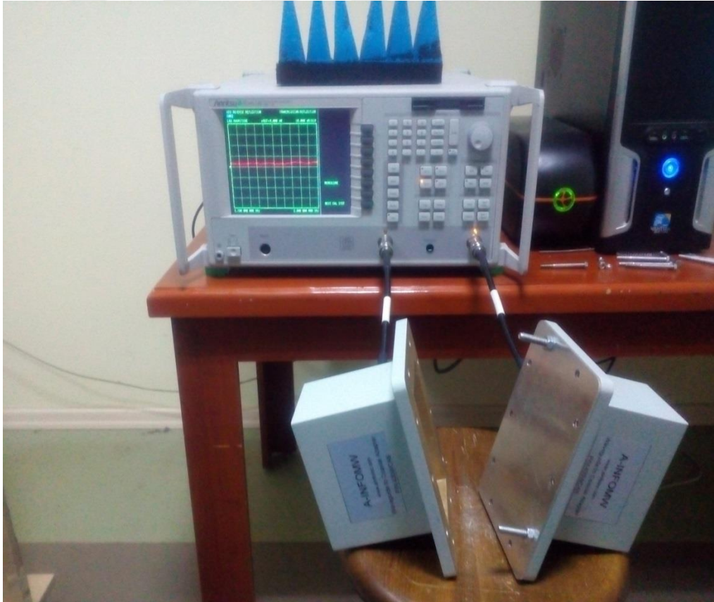
Şekil 4.4. 2. Portun yansımaya (reflect) ölçümü.
