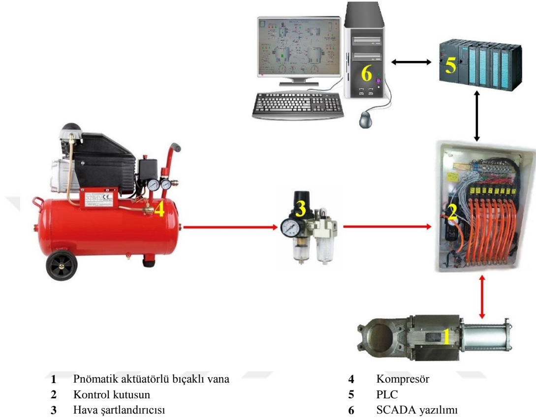
Şekil 5.12. Pnömatik vana kontrol sistemi.
