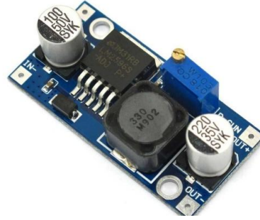
Şekil 4.18. 5V Güç kaynağı.
