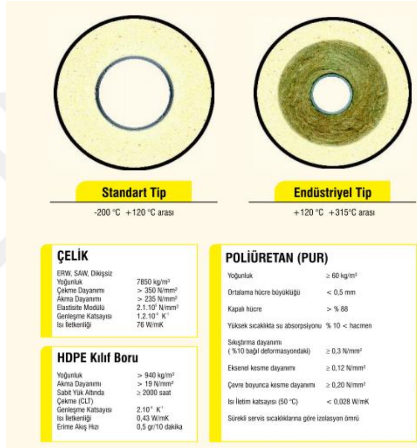
Şekil 3.2. Merkezi ana ısı dağıtım boruları.
