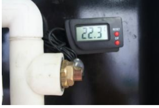
Şekil 3.10. Dijital prob uçlu termometre.
