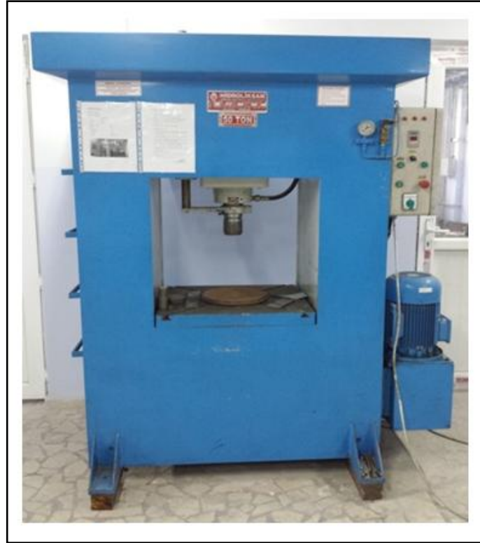
Şekil 6.3 Soğuk presleme işlemlerinde kullanılan hidrolik pres görüntüsü.
