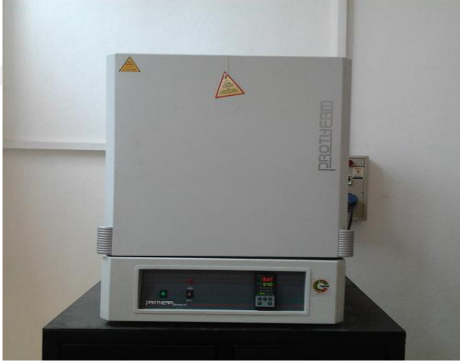
Şekil 6.5. Yaşlandırma ısı işlemlerinin yapıldığı fırın görüntüsü.
