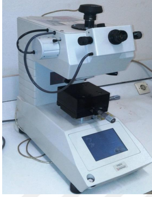
Şekil 6.6. Sertlik ölçümlerinin yapıldığı mikro sertlik cihazının görüntüsü.
