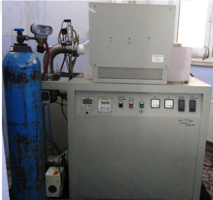
Şekil 6.4. Sinterleme işlemlerinin yapıldığı vakumlu ısıtıl işlem fırınının görüntüsü.
