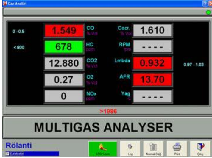
Şekil 4.14. Egzoz emisyon ölçüm cihazı.
