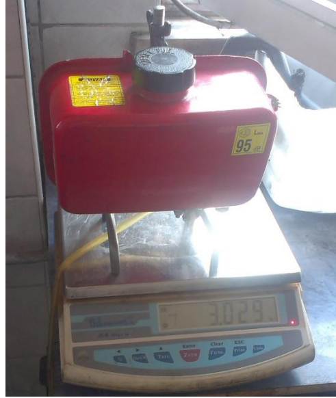
Şekil 4.13. Yakıt tüketimi ölçümü için kullanılan hassas terazi.
