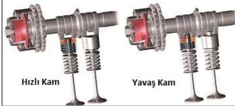
Şekil 3.7. VarioCam Plus, hidrolik faz aktüatör ve değişken supap iticileri (Wan, 2014).
