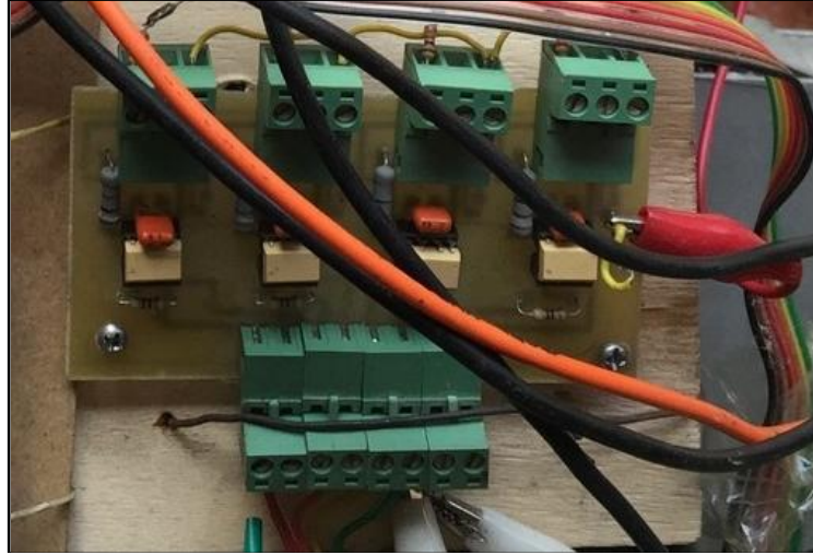
Şekil 4.7. TLP250 mosfet sürücü bloğu.
