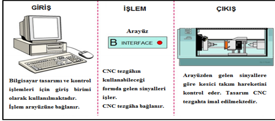
Şekil 3.1. CNC tezgahlar genel çalışma prensibi.
