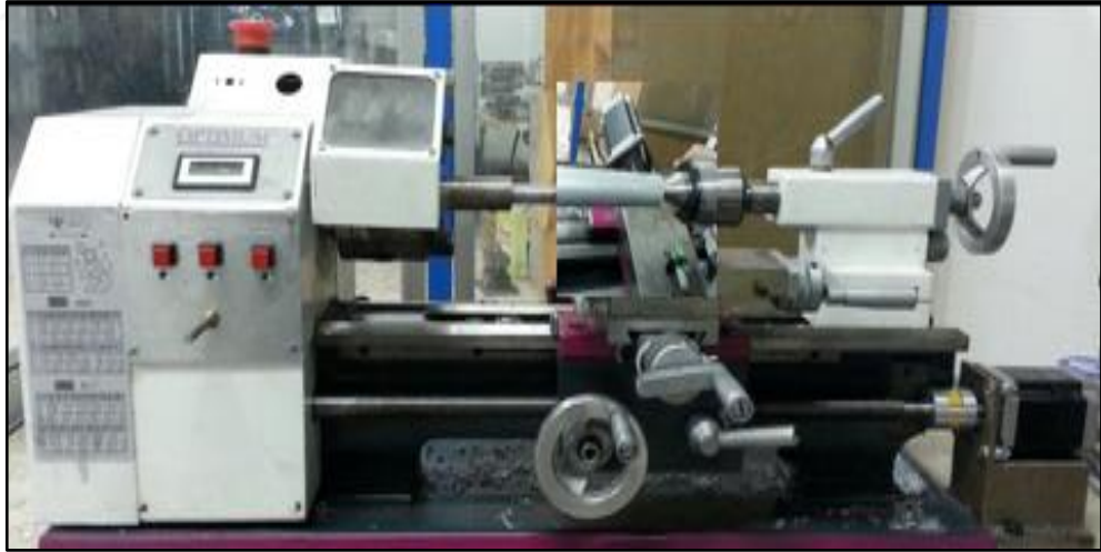
Şekil 4.9. Eksen motorları montajı sonrası torna tezgah görünümü.
