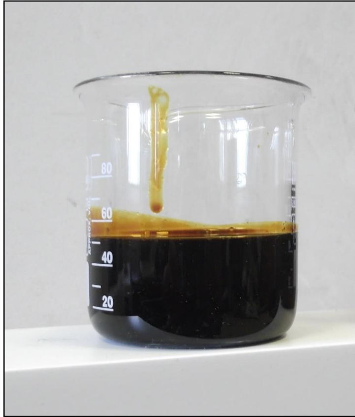
Şekil 2.2. Biyokütleden pirolizinden elde edilen biyoyağın görüntüsü.
