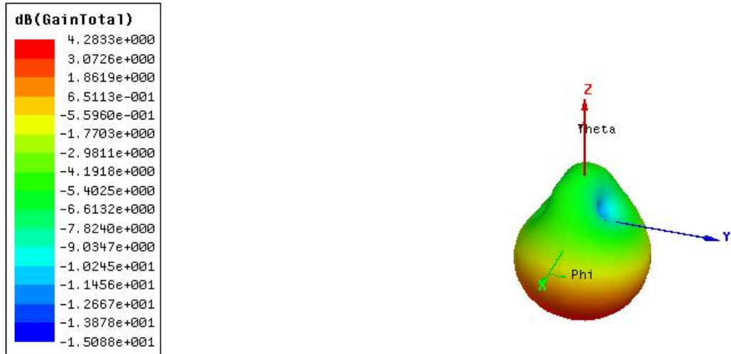
Şekil 4.17. Tasarlanan UMTS mikroşerit yama antenin 2.08 GHz frekansında 3-Boyutlu ışıma (kazanç) diyagramı.
