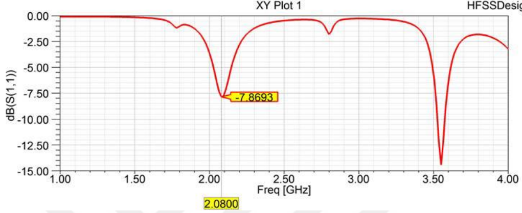
Şekil 4.5. L_1=40 mm (yama uzunluğu), L_2=40 mm (yama genişliği), L_1=34 mm (toprak zeminin uzunluğu), L_2=50 mm (toprak zeminin genişliği) için mikroşerit yama antenin S_{11} grafięi.
