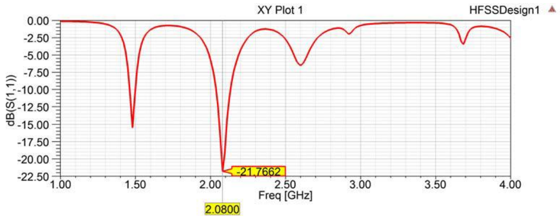
Şekil 4.14. Besleme noktasının koordinatları (-16, -39, 0) olan mikroşerit yama antenin S_{11} grafiği.
