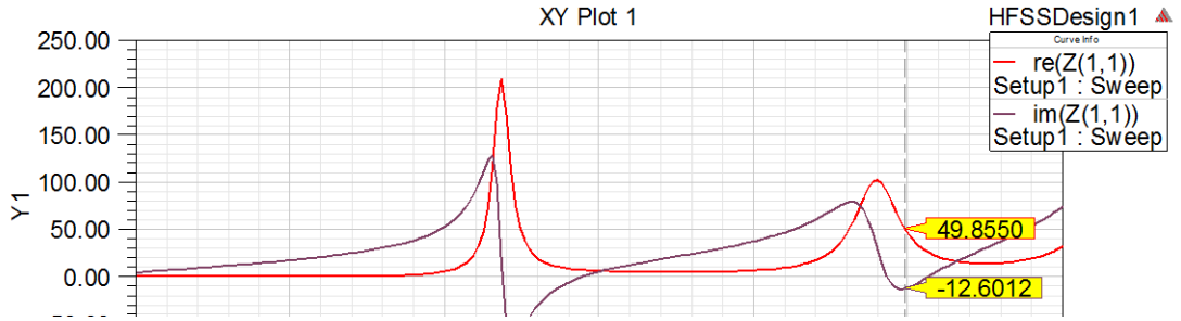
Şekil 4.35. Tasarlanan WiMAX mikroşerit yama antenin Z_{giriş} grafiği.
