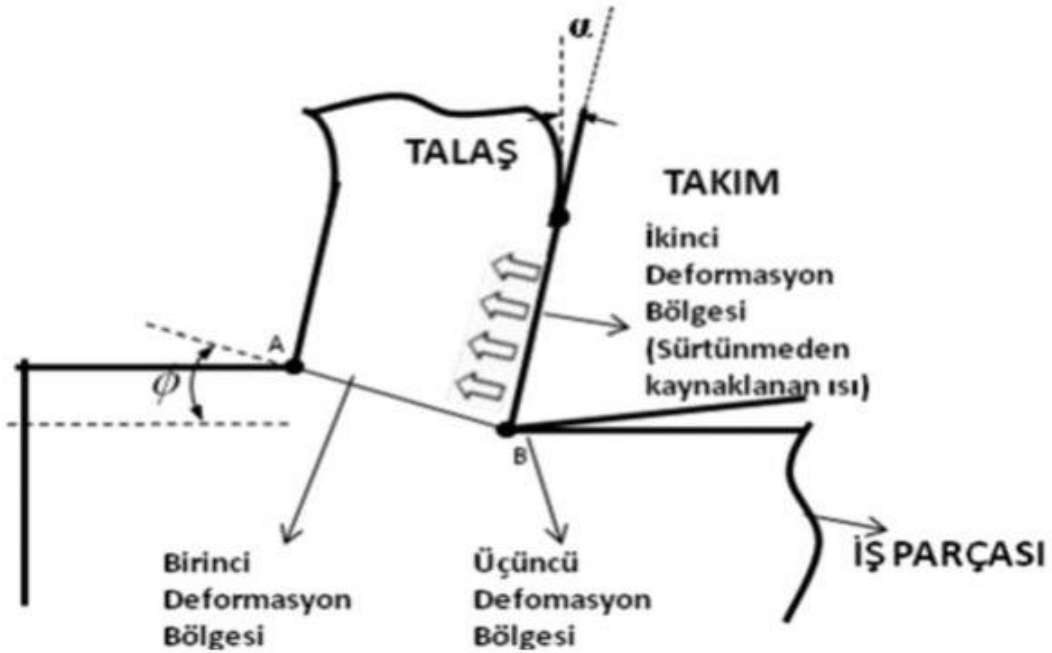
Şekil 4.1. Talaşlı imalatta deformasyon bölgeleri [24].
