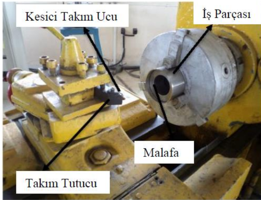
Şekil 4.3. Ortogonal kesmede kullanılan deney düzeneği [14].
