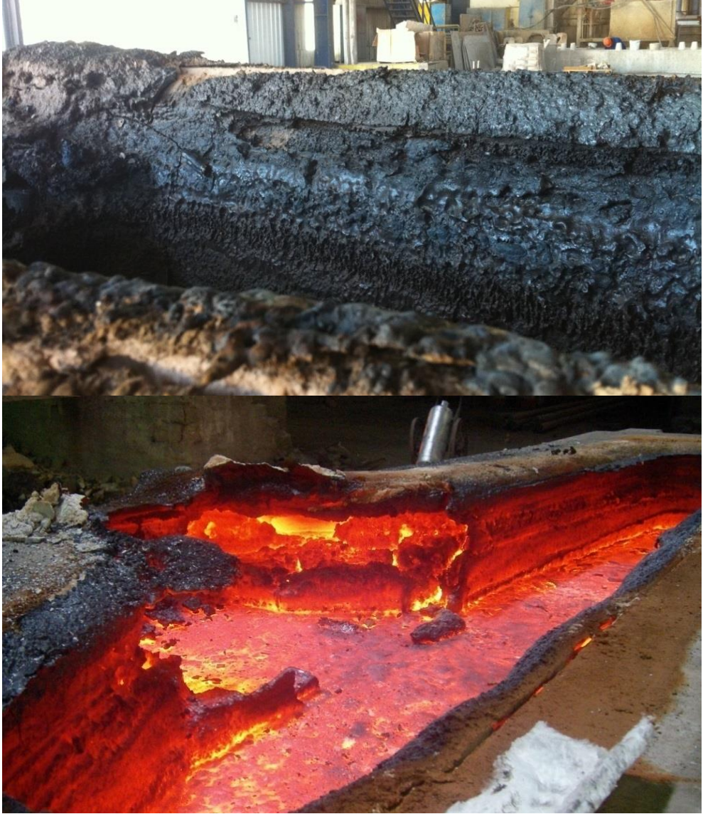
Şekil 3.10. Tandışlerdeki cüruf bölgesi aşınmaları.
