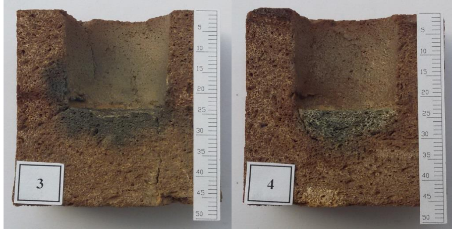
Şekil 5.3. Numune-3 ve Numune-4 (cüruf korozyon testi sonrası).
