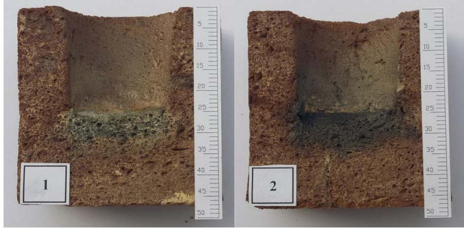
Şekil 5.2. Numune-1 ve Numune-2 (cüruf korozyon testi sonrası).
