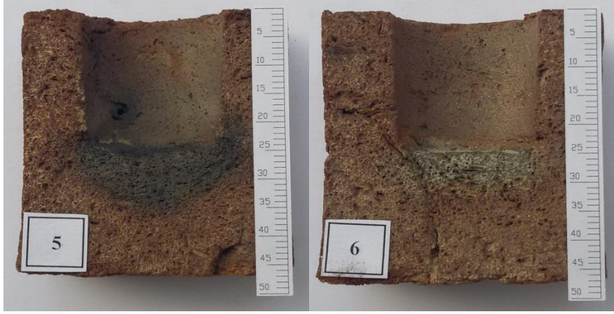
Şekil 5.4. Numune-5 ve Numune-6 (cüruf korozyon testi sonrası).
